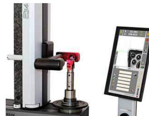
La tecnologia e la potenza di TID (Sistema Automatico di Identificazione Utensile) è disponibile su E346+. TID ti permette di far comunicare in modo bidirezionale il preset e il CNC per la trasmissione dei dati utensile.
